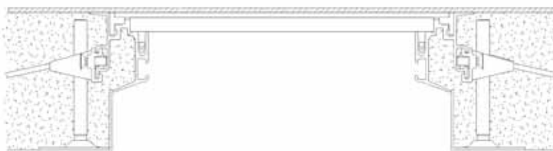
Padlócsatorna beépítése aljzatba
